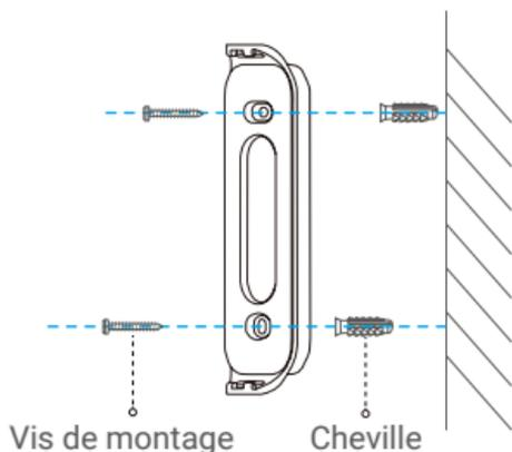
**i** Profondeur du trou recommandée : 25 à 30 mm.
